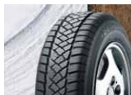
Dunlop SP LT 60 odlikuje dezen gazećeg sloja optimizovan za vožnju po putevima zimi. Centralno područje sa lamelama omogućava pouzdano prijanjanje na mokroj i zasneženoj podlozi. Duboki poprečni kanali i otvoreni rameni deo efikasno raspršuju vodu i sprečavaju akvaplaning.
